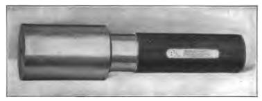
Fig. 82. Standard Plug Gage
