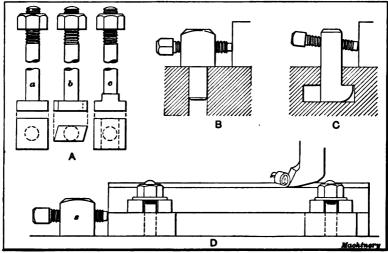
Fig. 20. Planer Clamping Bolts-Stop-pins-Use of Stop-pins
