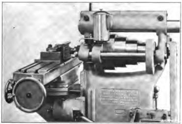
\* Fig. 26. Milling a Dovetail Groove
