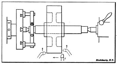
Fig. 25. Turning Pulley Held on Mandrel
