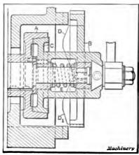
Fig. 4. Friction Feed Disk
