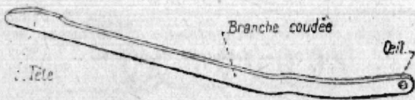
Fig. 18. — Ressort du levier de manœuvre.
