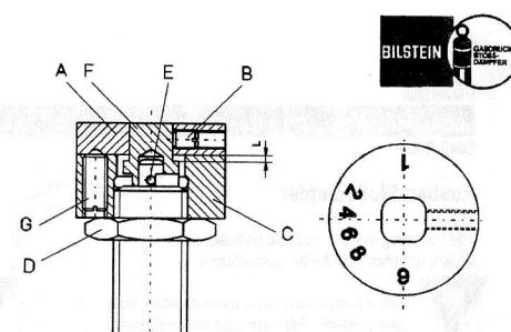
Verstellposition 9 = weich (im Uhrzeigersinn drehen)
