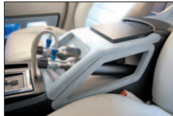
Unbegrenzte Möglichkeiten: Zwei Lachgaskartuschen für mehr Power (oben), eine Dachkonsole zur Bedienung der Anlage – falls der Computer mal nicht will.
