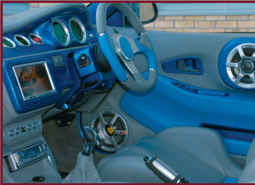
Zwei Coaxial-Speaker unterstützen das Zwei-Wege-System der Türen
