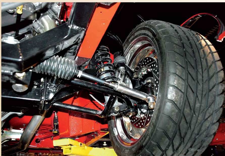
Die Hightech-Achse. Gut zu erkennen: die Zahnstangenlenkung und Coilovers. Zum Konzept des Wagens passen die innenbelüfteten, gelochten Bremsscheiben der Baer-Anlage. Offensichtlich will man nicht nur Gas geben.
