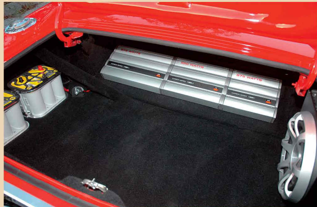
Da liegen schon ziemlich viele Watt im Kofferraum rum. Das „Reserverad“ rechts ist die Bassbox.
